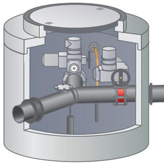
Der Umlenkschacht NeutraSwitch dient dazu, Flüssigkeiten mit unterschiedlichen Eigenschaften unterschiedlichen Entsorgungswegen zuzuleiten. Dazu wird eine Ableitung jeweils verschlossen und die andere geöffnet. Die Umschaltung kann manuell oder automatisch erfolgen. Im Normalbetrieb fließt das Wasser in die Kanalisation, bei Löscharbeiten fließt das Wasser in das Löschwasser-Rückhaltebecken.
