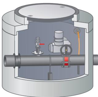
Der Absperrschacht NeutraBloc versperrt den Ablauf zur Kanalisation. Das Löschwasser kann in der Kanalisation, in einem Rückhaltebecken oder auf einer angeschlossenen Fläche zurückgehalten werden.
