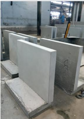
Bei der Anforderung „Sichtseite innen“ handelt es sich um Fertigteilelemente, deren horizontaler Fußschenkel „luftseitig“ eingebaut wird. Die freie, und damit sichtbare, Wandhöhe liegt somit auf der Seite des Fußschenkels (=innen).
