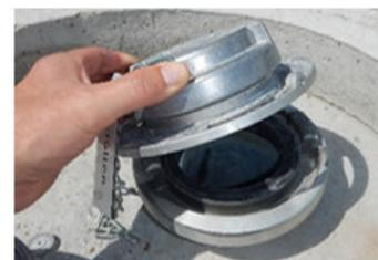
9. Pellet Maulwurf MW 6000 - E3 in die Betriebsposition bringen. Wahlschalter der Anschlussbox auf „Betrieb“ stellen.
