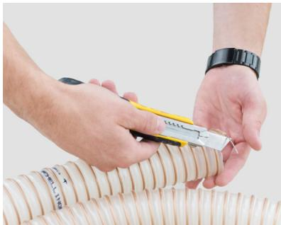
Bild 1 Erdung freilegen
