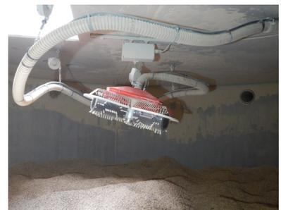
4. Kontrollieren: Der Saugschlauch darf während des Befüllens nicht unter den Befüll-Stutzen liegen! Wartungsöffnung verschließen.
