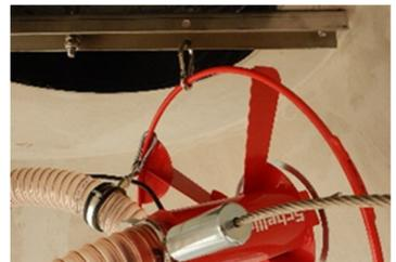
4. Kontrollieren: Der Saugschlauch darf während des Befüllens nicht unter dem Befüll Stutzen liegen! Kunststoffdeckel verschließen
