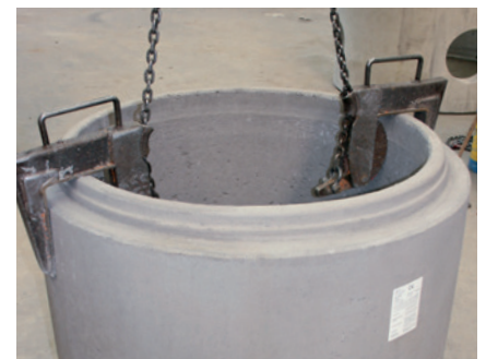
Bild 3: Schachtgehänge mit Klauen
